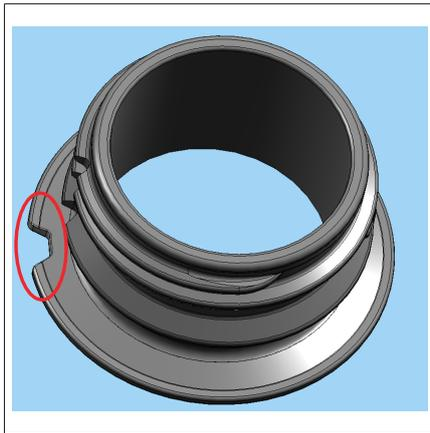
Fig. 14: Rebaje en el anillo de soporte
