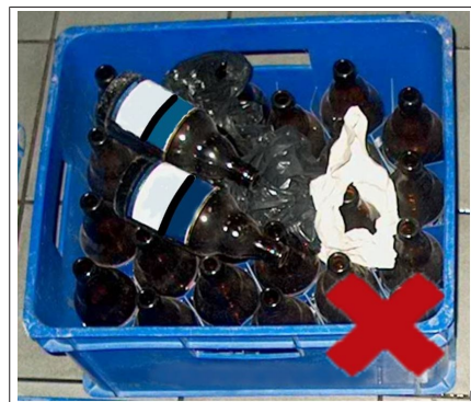
Fig. 48: Corpos estranhos e garrafas de vidro mal orientadas na caixa
