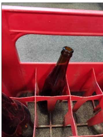
Fig. 59: Garrafa de vidro não assente em toda a superfície no fundo da caixa
