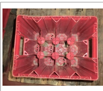
Fig. 42: Parede da caixa ligeiramente comprimida
