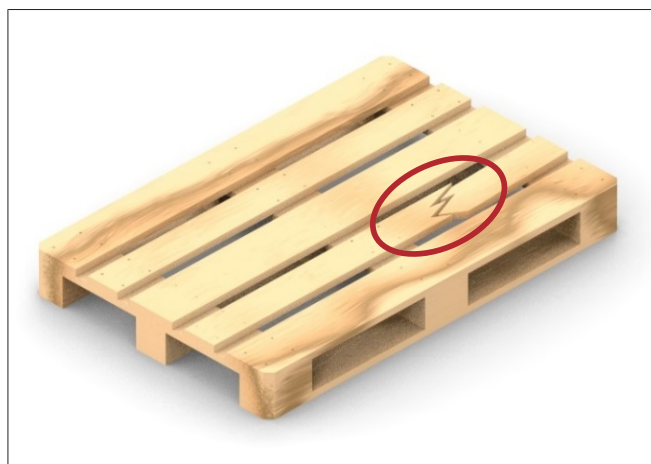
Fig. 77: Assim que uma tábua estiver quebrada na transversal ou na diagonal.
