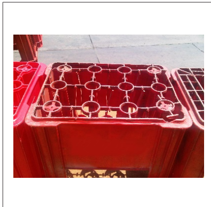
Fig. 40: Fundo da caixa ligeiramente quebrado
