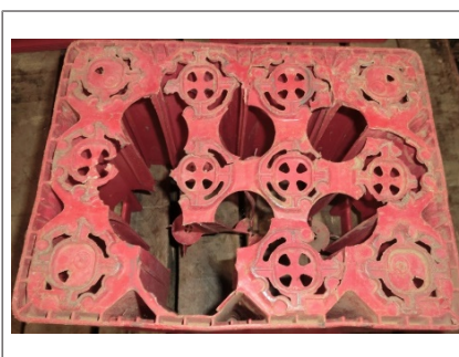
Fig. 44: Fundo da caixa quebrado
