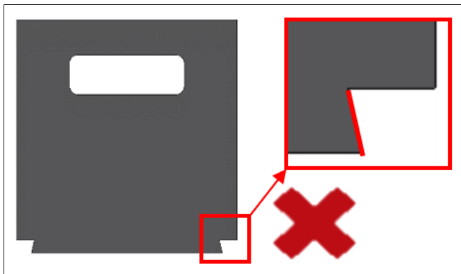
Fig. 53: Modelo de caixa mais antigo com geometria de encaixe desfavorável
