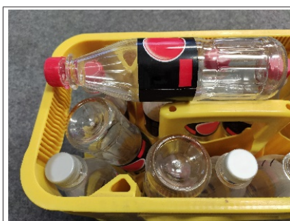
Fig. 43: Garrafas PET danificadas e mal orientadas
