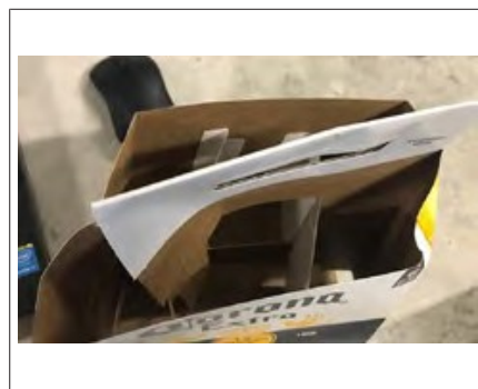
Рис. 90: Деформация от раскря
