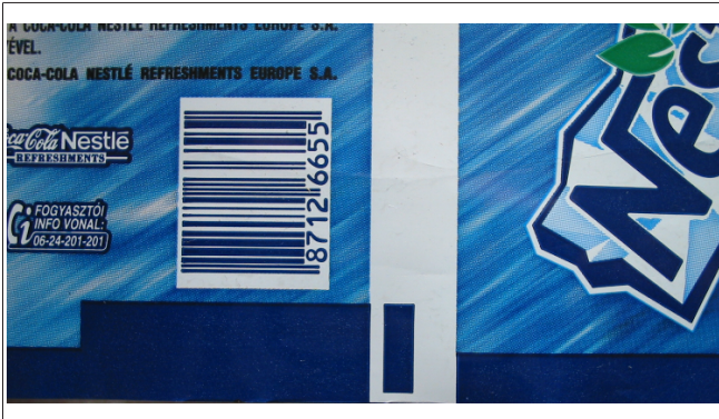
图 93: 在切割标记前后的扫描区域中有一种以上的颜色
