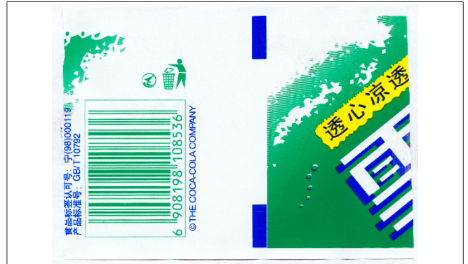
图 94: 在切割标记前后的扫描区域中有一种以上的颜色
