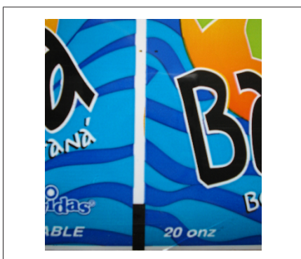
图 90: 在切割标记前后的扫描区域中有一种以上的颜色，并且颜色对比度不足
