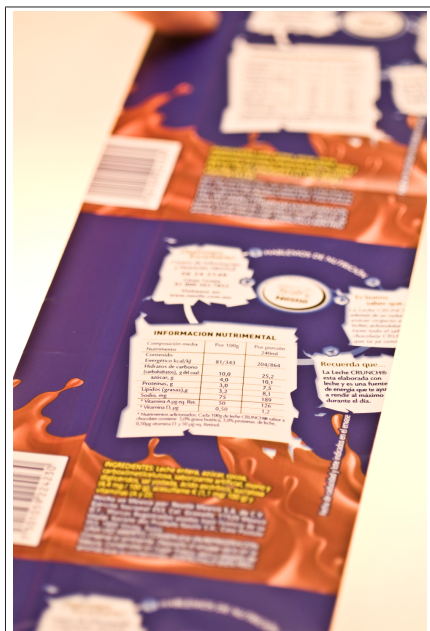
Рис. 118: НЕ читаемая люминесцентная метка отрезания
