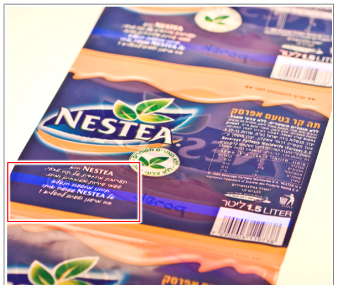
Рис. 117: Читаемая люминесцентная метка отрезания
