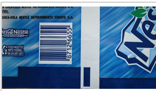
Рис. 93: Более одного цвета в зоне сканирования до и после метки отрезания
