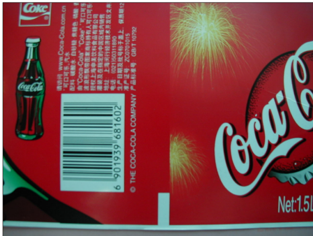
Рис. 84: Пример для метки отрезания на нижнем крае этикетки
