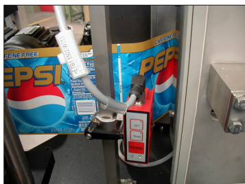
Рис. 73: Сканирование метки отрезания сенсорным датчиком
