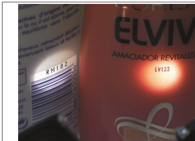
Рис. 14: Нанесение датирования горячим тиснением
