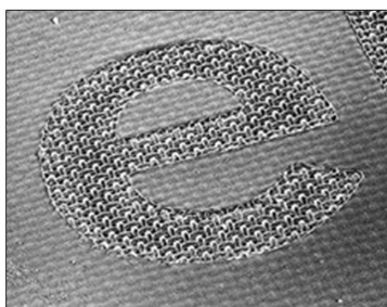
Рис. 6: Микроскопическое изображение формы для трафаретной печати
