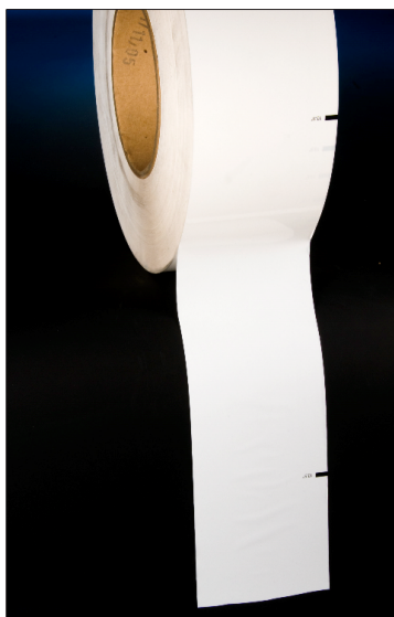
Рис. 62: Пример сильного электростатического заряда
