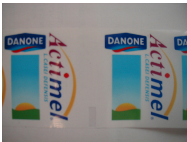
Рис. 88: Пример прозрачной этикетки с прозрачной меткой отрезания без печати
