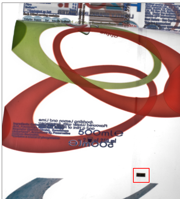
Рис. 120: Читаемая метка отрезания по цветовому контрасту
