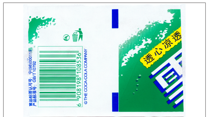
Рис. 94: Более одного цвета в зоне сканирования до и после метки отрезания
