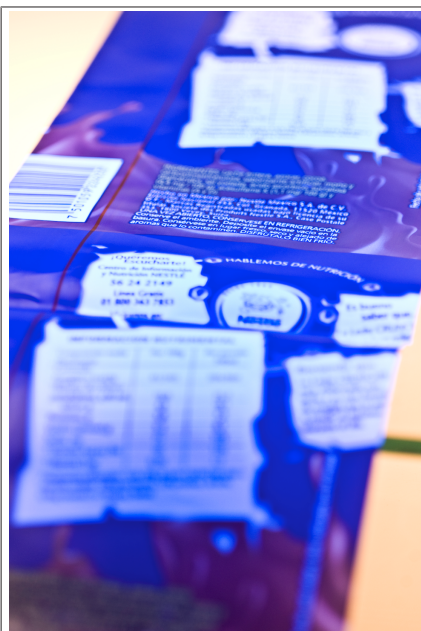
Рис. 119: НЕ читаемая люминесцентная метка отрезания
