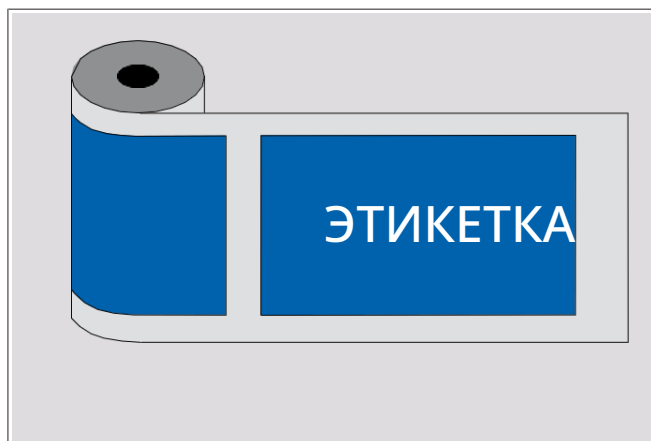
Рис. 101: Направление движения в машине справа - налево
