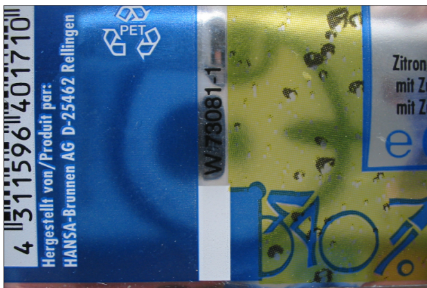
Рис. 82: Пример для метки отрезания на нижнем крае этикетки
