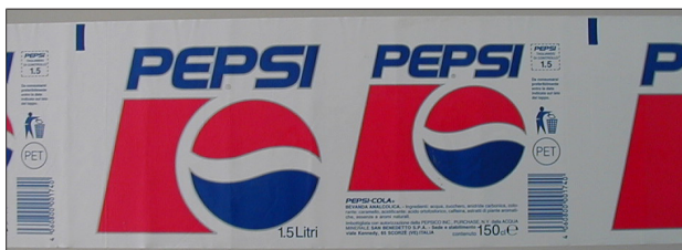
Рис. 83: Пример для метки отрезания на верхнем крае этикетки
