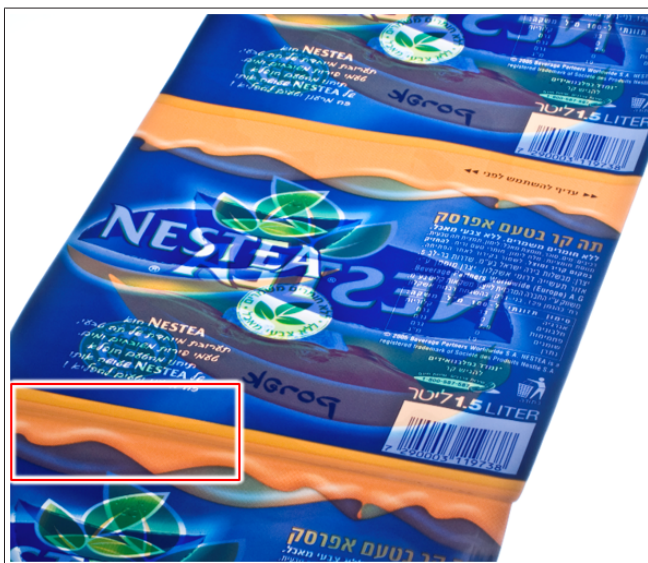
Рис. 116: Читаемая люминесцентная метка отрезания
