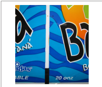
Рис. 90: Более одного цвета в зоне сканирования до и после метки отрезания и недостаточный цветовой контраст
