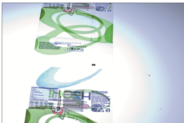
Рис. 126: НЕ функциональная метка отрезания
