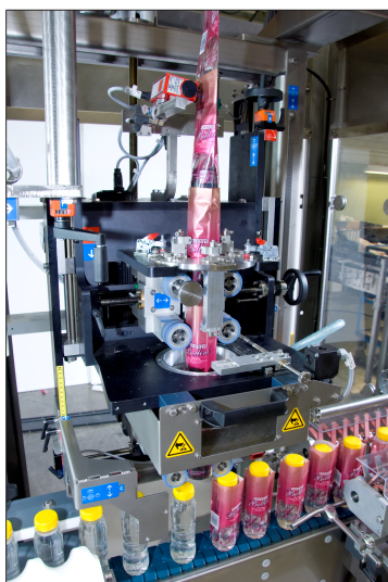
Рис. 114: Пример сенсорного сканирования метки отрезания
