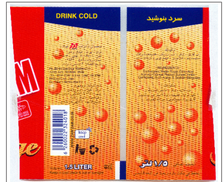
Fig. 92: Mais do que uma cor na zona de detecção antes e depois da marca de corte e tamanho mínimo da zona de detecção não considerado
