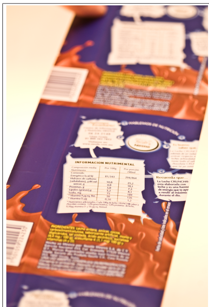
Fig. 118: Marca de corte de luminescência NÃO legível
