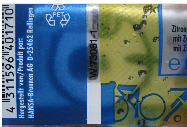
Fig. 82: Exemplo para uma marca de corte na borda inferior do rótulo
