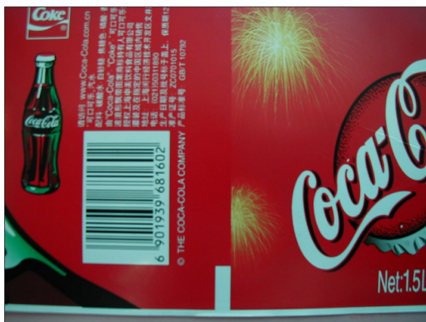
Fig. 84: Exemplo para uma marca de corte na borda inferior do canto
