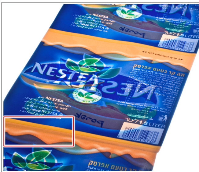
Fig. 116: Marca de corte de luminescência legível
