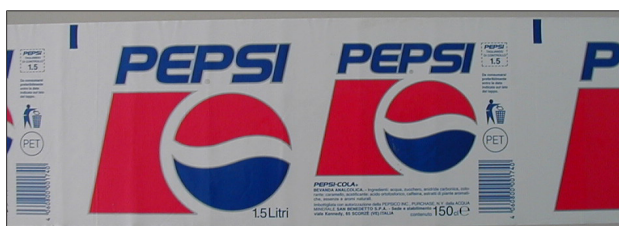
Fig. 83: Exemplo para uma marca de corte na borda superior do rótulo
