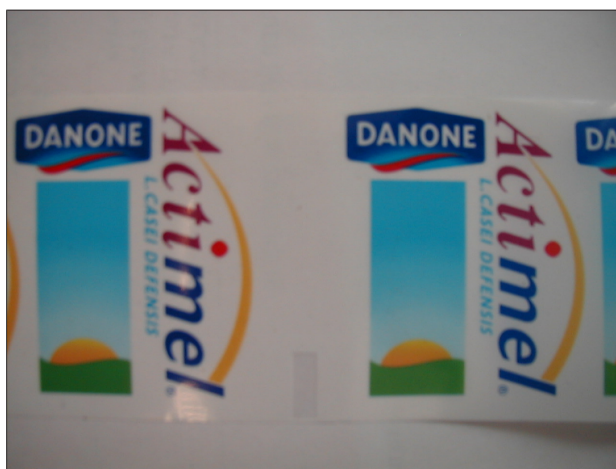
Fig. 88: Exemplo para um rótulo transparente com marca de corte transparente não impressa
