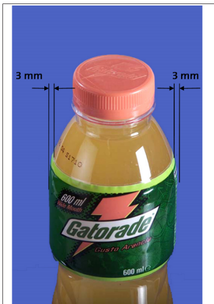
Fig. 70: Exemplos para aplicações retráteis com cola quente
