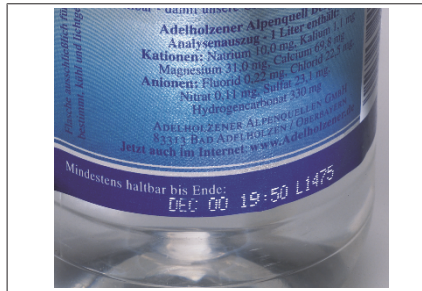
Fig. 15: Datação a laser
