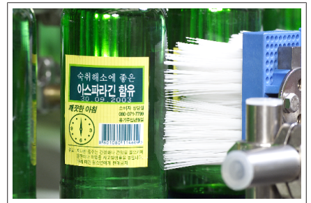
Fig. 16: Datação a jato de tinta
