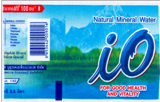
Fig. 89: Marca de corte azul em fundo azul, contraste de cor não suficiente
