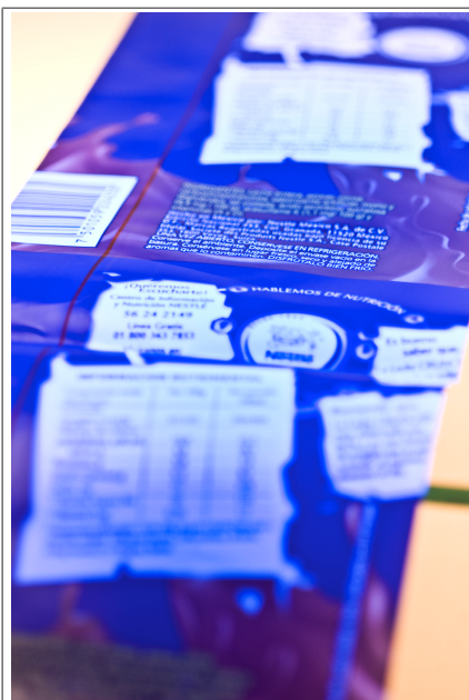
Fig. 119: Marca de corte de luminescência NÃO legível
