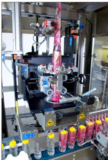
Fig. 114: Esempio di rilevamento di una tacca di taglio da parte di un sensore
