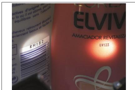
Fig. 14: Codifica con goffratura a caldo
