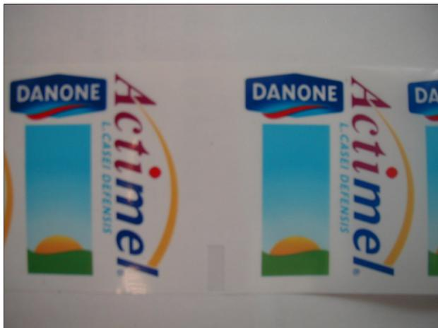
Fig. 88: Esempio di un'etichetta trasparente con una tacca di taglio trasparente non stampata
