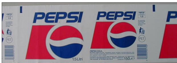
Fig. 83: Esempio di una tacca di taglio sul bordo superiore dell'etichetta
