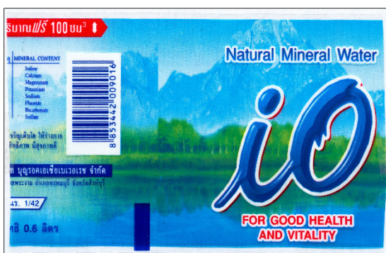
Fig. 89: Repère de coupe bleu sur fond bleu, contraste de couleur pas suffisant
