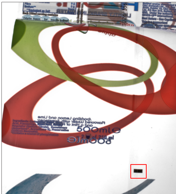
Fig. 120: Repères de coupe à contraste de couleur lisibles
