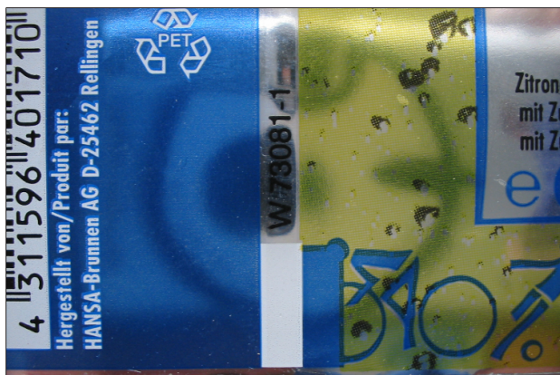
Fig. 82: Exemple de repère de coupe sur le bord inférieur de l'étiquette
