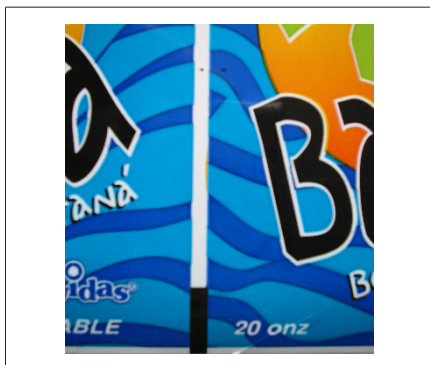
Fig. 90: Plusieurs couleurs dans la zone de détection avant et après le repère de coupe et contraste de couleur pas suffisant
