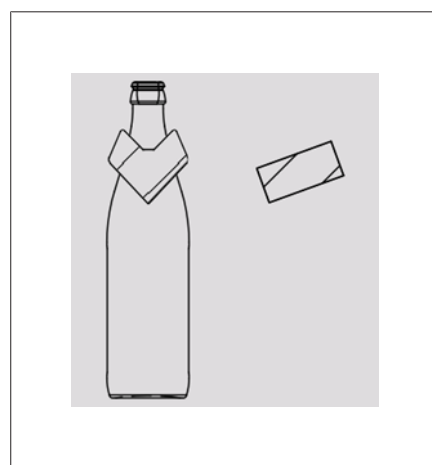
Fig. 22: Collerette de forme spéciale : formes au choix ; au niveau de la collerette du récipient
