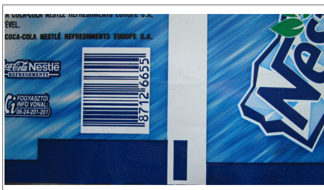
Fig. 93: Plusieurs couleurs dans la zone de détection avant et après le repère de coupe
