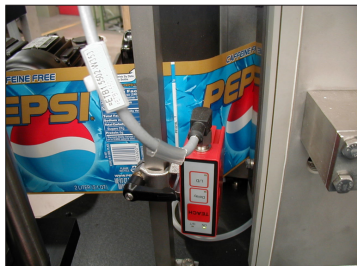
Fig. 73: Détection sensorielle d'un repère de coupe
