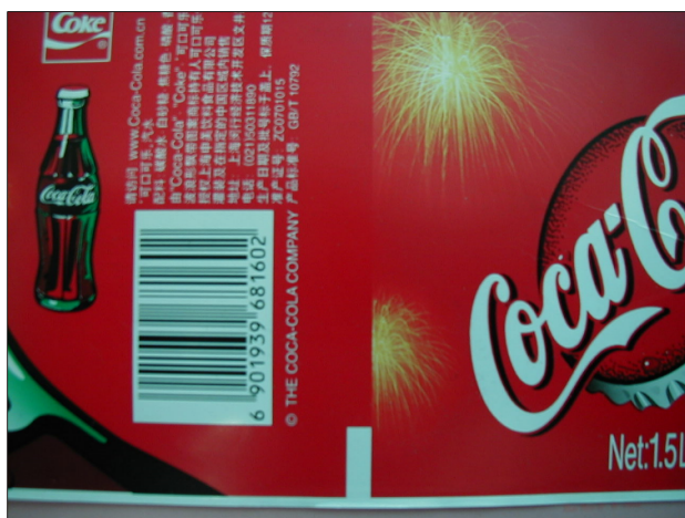
Fig. 84: Exemple de repère de coupe sur le bord inférieur de l'étiquette
