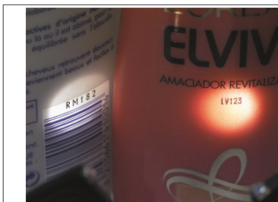
Fig. 14: Datage par estampage à chaud
