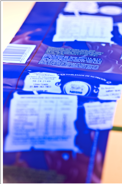
Fig. 119: Repères de coupe luminescents PAS lisibles
