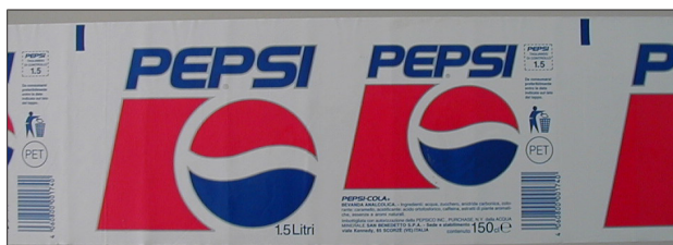
Fig. 83: Exemple de repère de coupe sur le bord supérieur de l'étiquette
