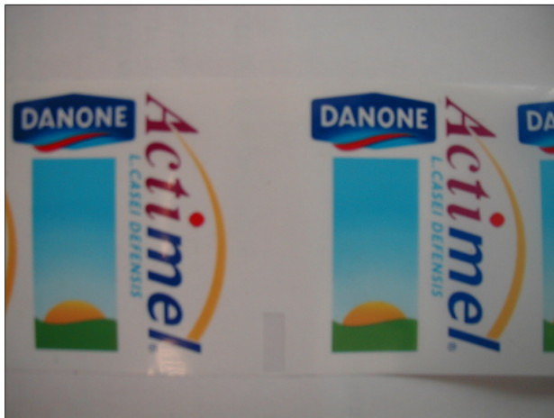
Fig. 88: Exemple d'étiquette transparente avec repère de coupe transparent, non imprimé
