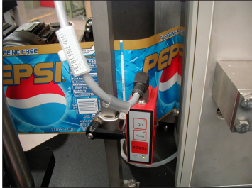
Fig. 73: Detección por sensor de la marca de corte
