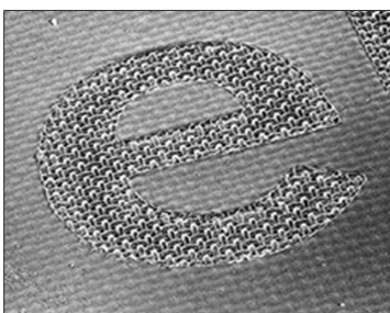
Fig. 6: Imagen microscópica de una serigrafía
