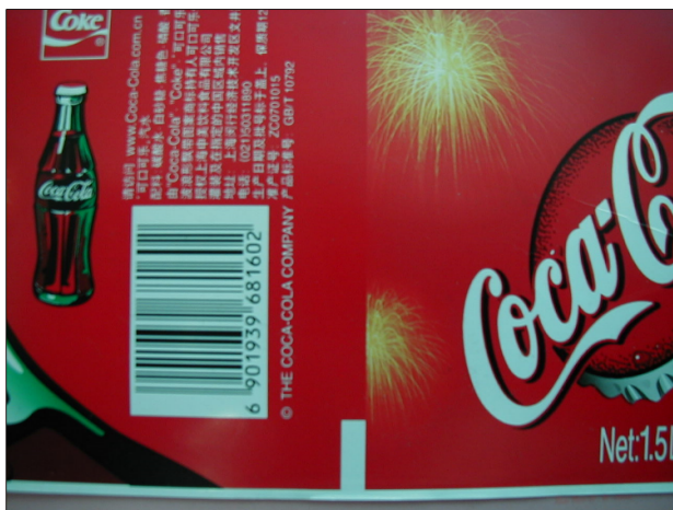
Fig. 84: Ejemplo de marca de corte en el borde inferior de la etiqueta
