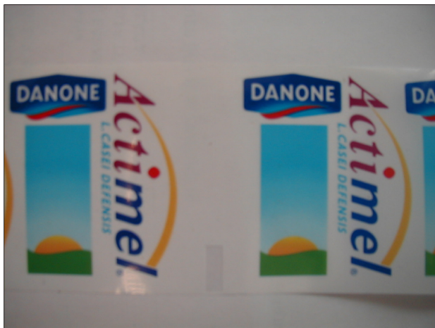
Fig. 88: Ejemplo de etiqueta transparente con marca de corte transparente no impresa
