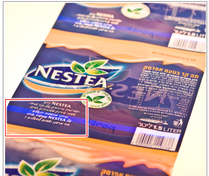
Fig. 117: Marca de corte luminiscente legible
