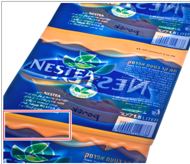
Fig. 116: Marca de corte luminiscente legible
