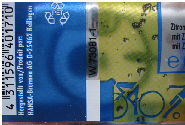
Fig. 82: Ejemplo de marca de corte en el borde inferior de la etiqueta
