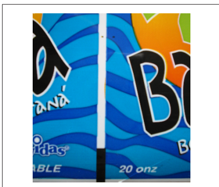
Fig. 90: Más de un color dentro del área de exploración antes y después de la marca de corte y contraste de color insuficiente
