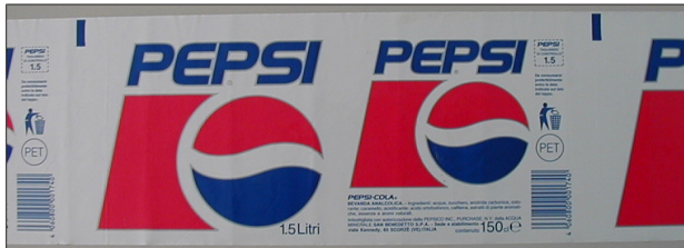
Fig. 83: Ejemplo de marca de corte en el borde superior de la etiqueta
