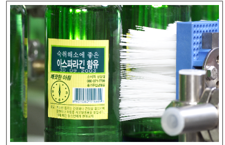
Fig. 16: Dispositivo codificador por chorro de tinta
