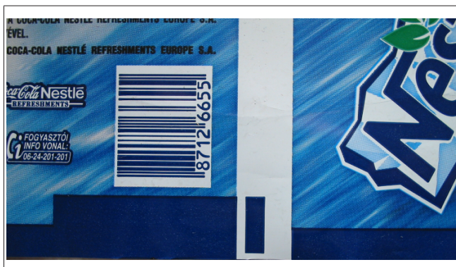
Abb. 93: Mehr als eine Farbe im Abtastbereich vor und nach der Schnittmarke
