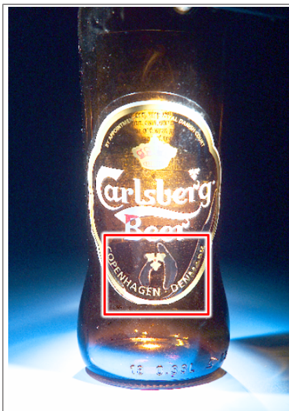
Abb. 99: Beispiel für Luft einschüsse
