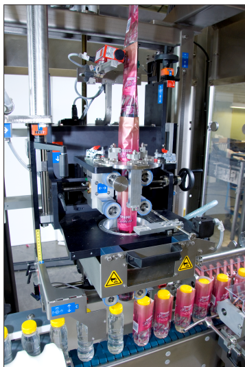
Abb. 114: Beispiel für die sensorische Abtastung einer Schnittmarke
