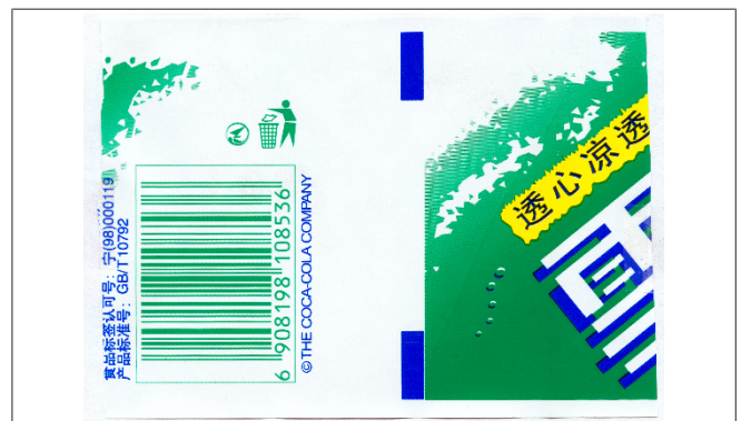
Abb. 94: Mehr als eine Farbe im Abtastbereich vor und nach der Schnittmarke
