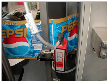
Abb. 73: Sensorische Abtastung einer Schnittmarke
