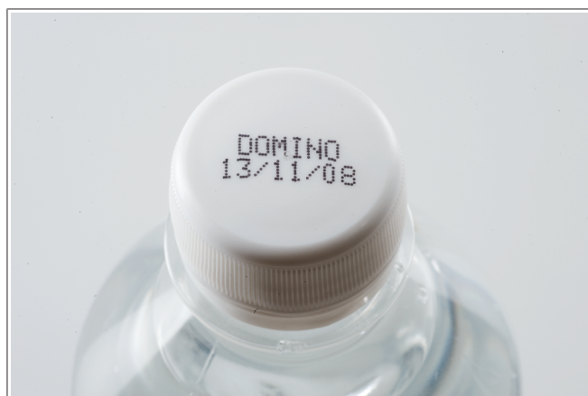
Fig. 9: Datage au jet d'encre sur le bouchon
