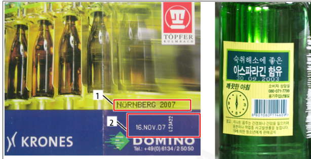
Fig. 1: Exemple de datage au jet d'encre et laser
