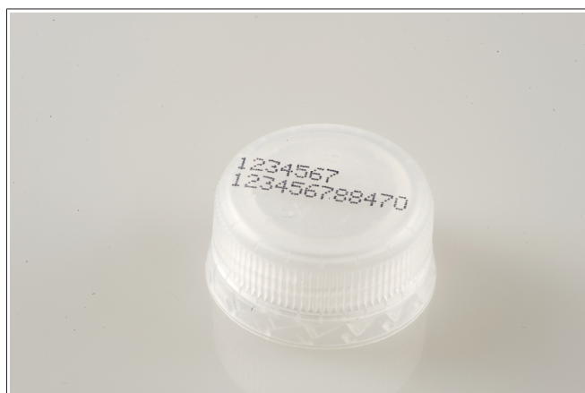
Fig. 8: Datage au jet d'encre sur le bouchon
