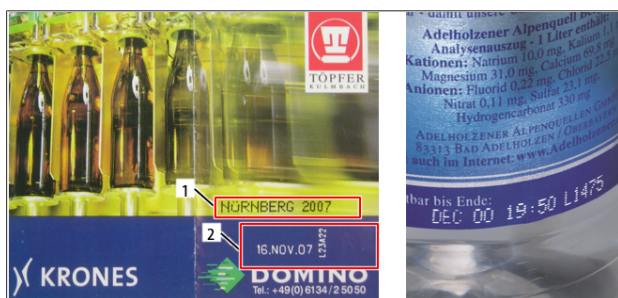
Fig. 2: Exemple de datage au jet d'encre et laser
