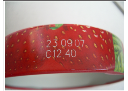
Fig. 12: Datage laser sur bouchon métallique
