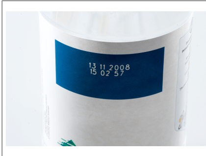
Fig. 11: Couche de peinture foncée (laser d'écriture)
