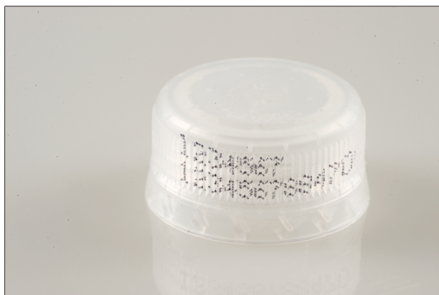
Fig. 7: Datage au jet d'encre sur les rainures
