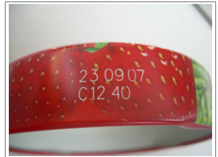
Fig. 12: Codificación por láser sobre tapón metálico
