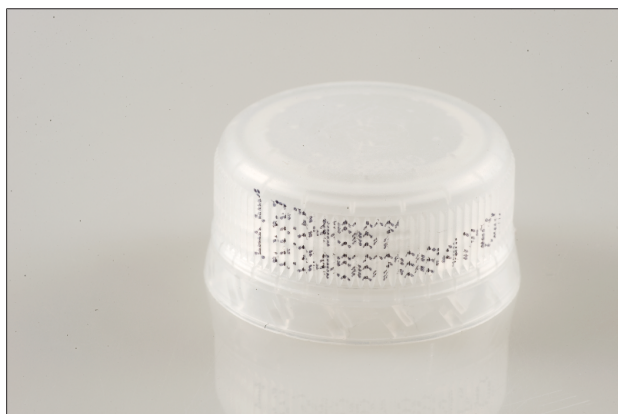
Fig. 7: Codificación con chorro de tinta sobre ranuras
