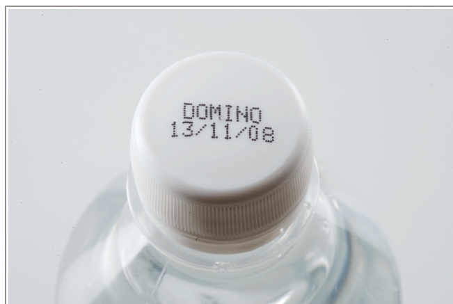
Fig. 9: Codificación con chorro de tinta sobre el tapón
