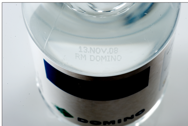
Fig. 5: Codificación por láser de trazado en la botella
