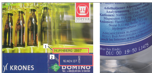
Fig. 2: Ejemplo de dispositivo codificador láser y por chorro de tinta
