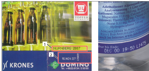
Abb. 2: Beispiel für Inkjet- und Laserdatierung
