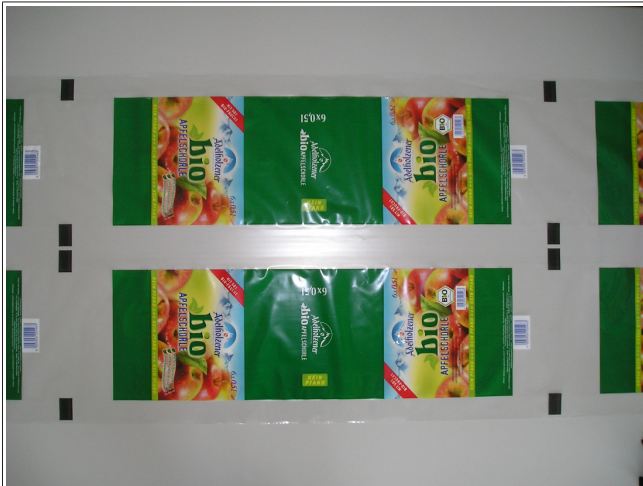
Abb. 13: Beispiel für Foliendatierung (Barcode)
