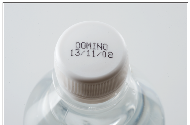
Abb. 9: Inkjet-Datierung auf Verschluss
